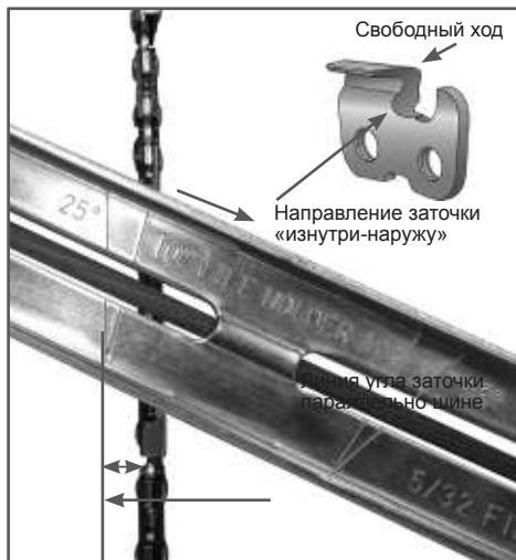
Рис. 22 Расположение линии угла заточки
