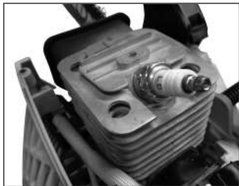
Рис. 28 Охлаждающие ребра цилиндра
