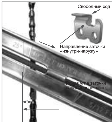
Рис. 22 Расположение линии угла заточки
