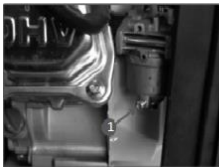
Рис. 24 Обслуживание фильтра отстойника Т-50 1. Винт
