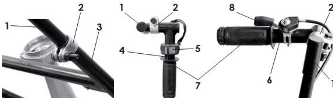
Рис. 2 - Установка стоек с рукоятками управления
